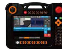
一度使ったら戻れない直観的な操作性を実現。従来の関節値を羅列する複雑なプログラミングからユーザーを開放し、3D グラフィクスと MUJIN 独自言語 ITL を用いることで、誰もが扱えるロボットへ。
