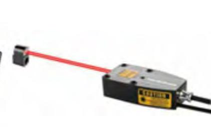
レーザー反射鏡干渉計
