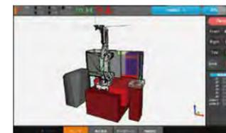
実機と切り離して、作成したプログラムをシミュレーション上で事前確認可能。また、レイアウト変更やタスク変更に対しても、あらかじめシミュレーション上で動作を作成し、テストすることで、実機を垂直立上げ。
